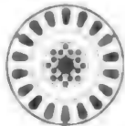
Жалюзи капота мотора устанавливались только для полетов в холодном климате
